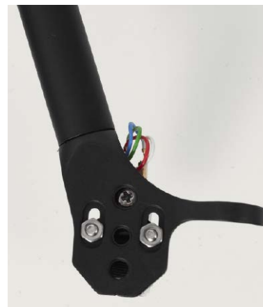
Główka jest zintegrowana z rurką ramienia, sposób montażu wkładki jest tym razem standardowy, a więc na dwie, a nie jak zwykle u Regi, trzy śruby.
